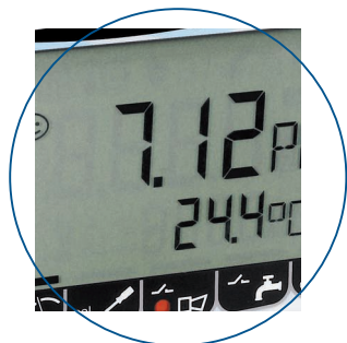
Автоматическая самодиагностика: смайлики отображают состояние датчика.
