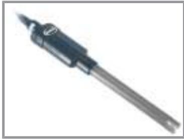
Стандартный комбинированный гелевый pH-электрод с двойной диафрагмой и встроенным датчиком температуры, для цифровых измерителей. Предназначено для использования в лаборатории. Сертифицировано в соответствии с нормами MCERT.
