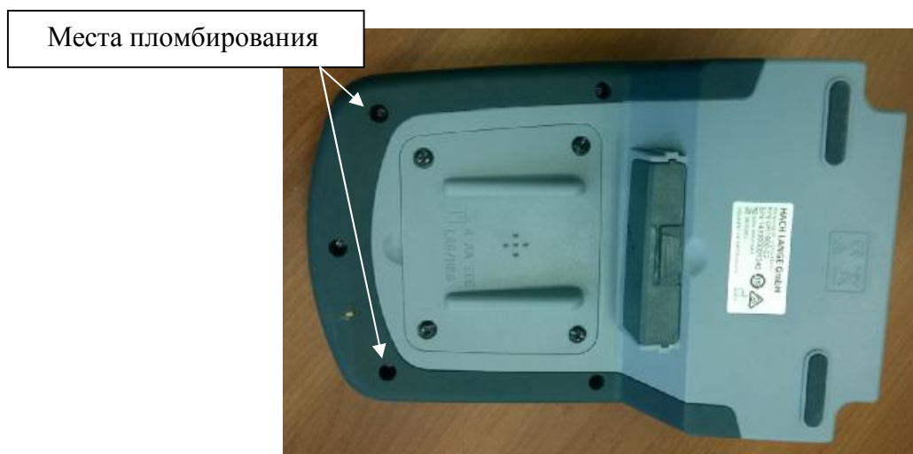
Рисунок 2 – Места пломбирования спектрофотометров DR 1900 (вид снизу)
